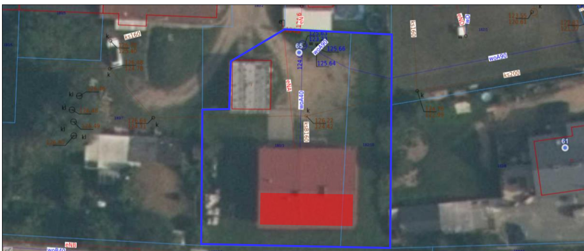
Rys. 40 Kopia mapy zasadniczej dz. 220408_2.0004.AR_1.180/3 i 182/10 z oznaczonym na czerwono obszarem zabudowy.
