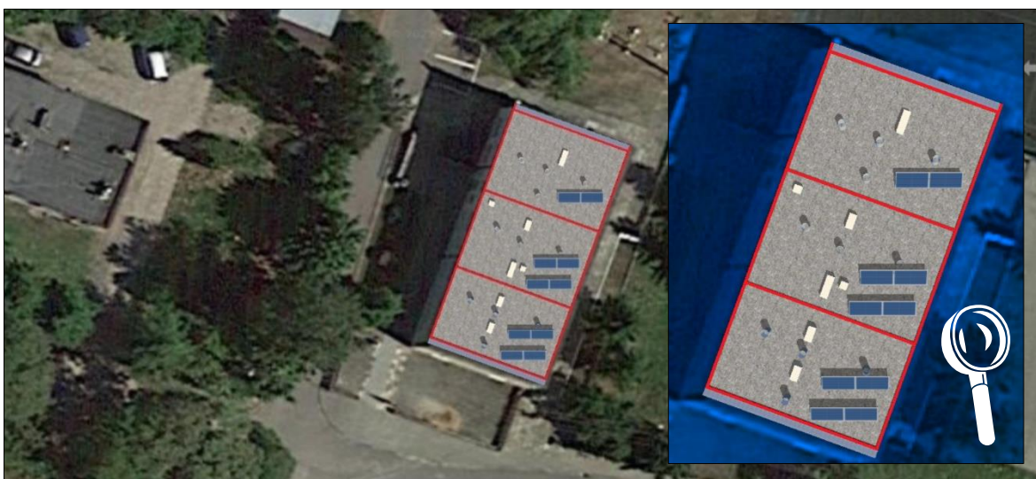
Rys. 57 Propozycja zakresu prac w ramach zamierzenia w obrębie połaci dachowych GOKSIR w Trąbkach Wielkich.
