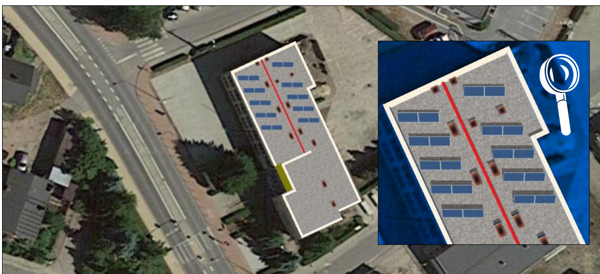
Rys. 9 Propozycja zakresu prac w ramach zamierzenia w obrębie połaci dachu obiektu Urzędu Gminy w Trąbkach Wielkich.
